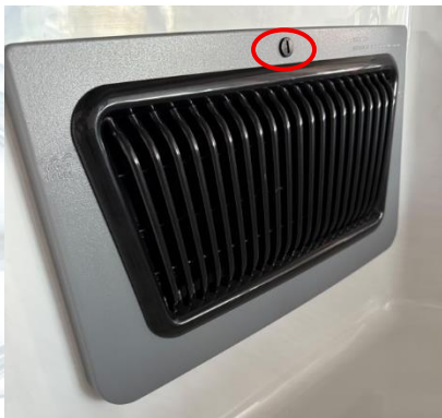
1. Entnehmen Sie die Schraube der Filterabdeckung
