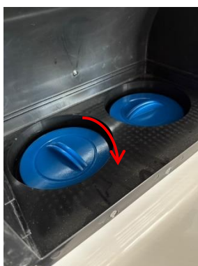
5. Drehen Sie die Filter im Uhrzeigersinn an
