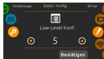
Um die low-level Konfiguration, die Anzahl der Phasen sowie die Stromstärke Ihres Systems einzustellen, bewegen Sie das rechte Rad, bis das Symbol für die elektrische Konfiguration in der Mitte hell leuchtet.
